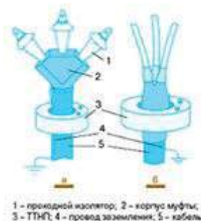
Рисунок ба, бб. Правила заземления заземляющей жилы кабеля
