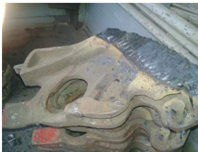
Рис.2. Наплавленный замок автосцепки вагона
